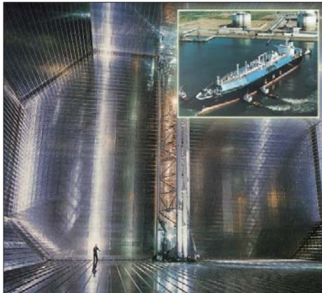
Figure 2.2 Cuve en Invar d'un méthanier. Le personnage, en bas à gauche, donne l'échelle.
